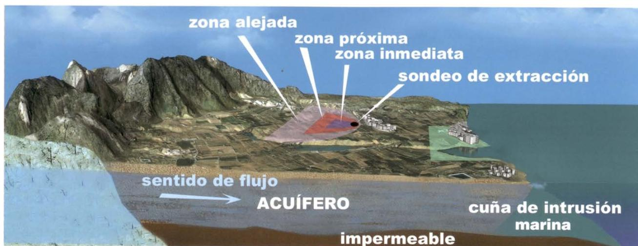
Ilustración 26: Zonas de protección de una captación (pozo).
