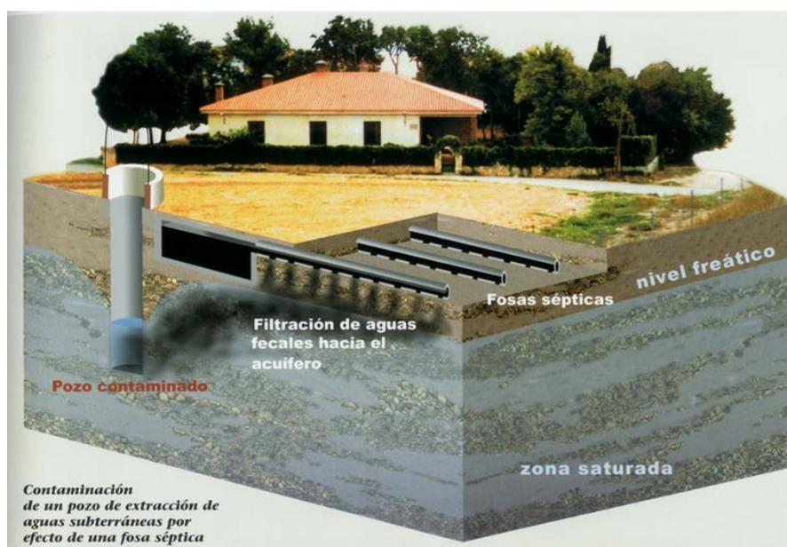
Ilustración 24: Contaminación del agua en un pozo por efecto de una fosa séptica.
