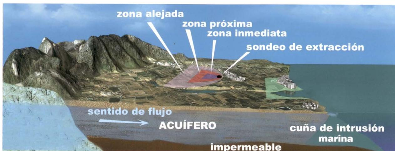
Ilustración 23: Concepto y esquema de perímetros de protección.
