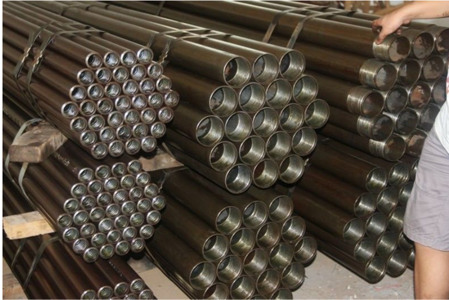
Foto 24: barras o tubos de perforación de diamantina.
