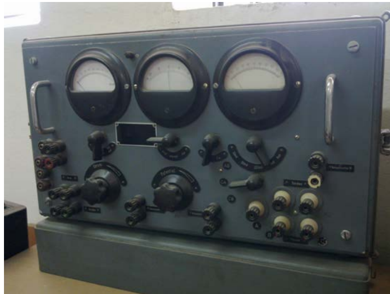
Foto 1: Equipo de prospección eléctrica en corriente continua (1970 – 1980).
