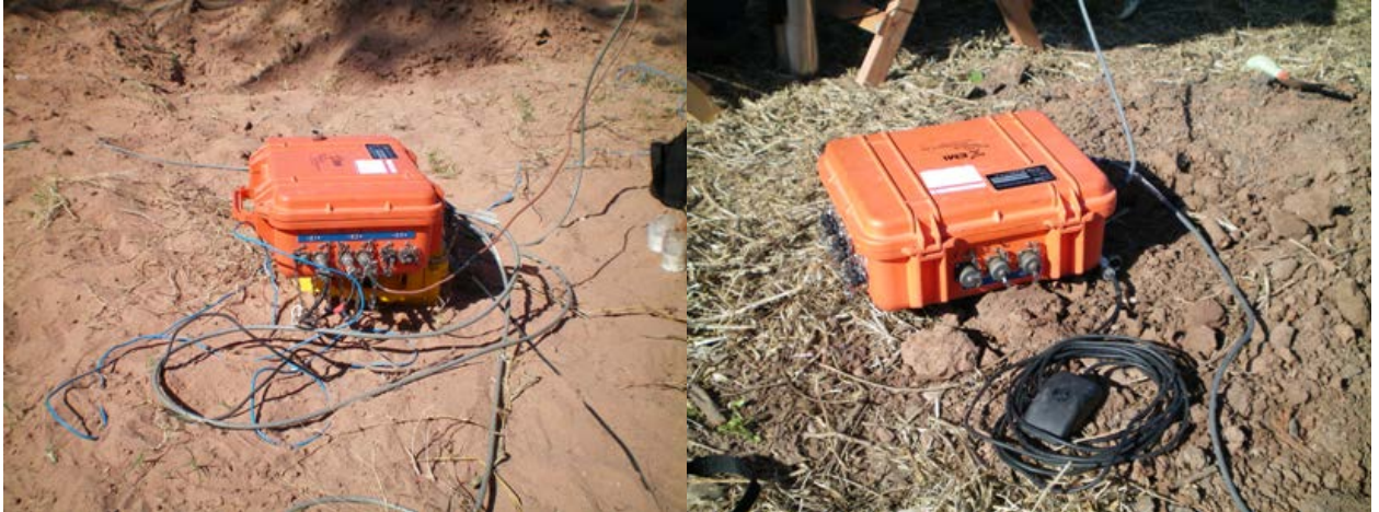
Foto 6: Equipo EMI. A la izquierda con conexiones a las barras magnéticas X, Y, Z y a los electrodos MN. A la derecha, conexión al sistema de GPS y PC. Gentileza del INGEIS.
