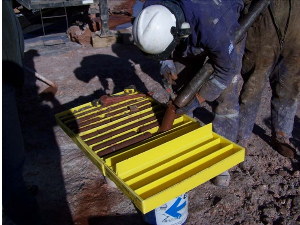
Foto 28: Extracción de la corona testigo del barril y almacenamiento en cajas de logeo.
