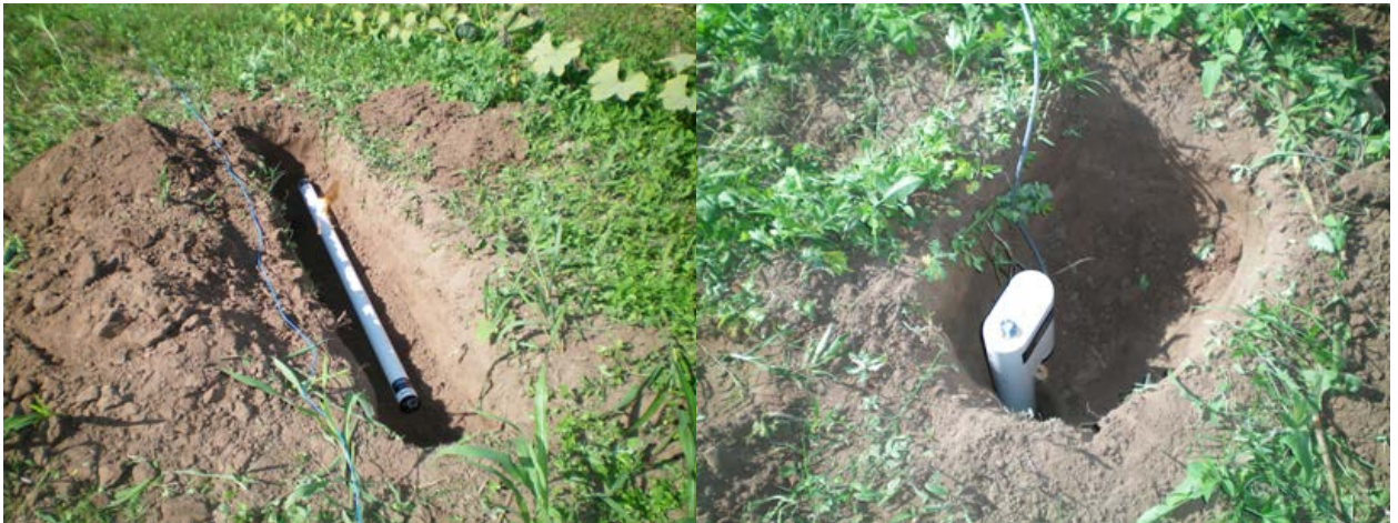
Foto 7: A la izquierda barra magnética X. A la derecha, barra magnética vertical (Z). En todos los casos las tres componentes del campo magnético se encuentran enterradas.
