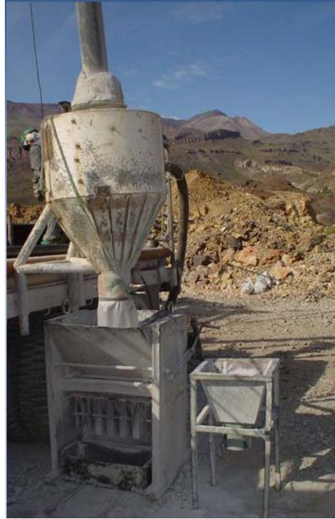
Foto 32: Ciclón, con bolsa para recoger el cutting.
