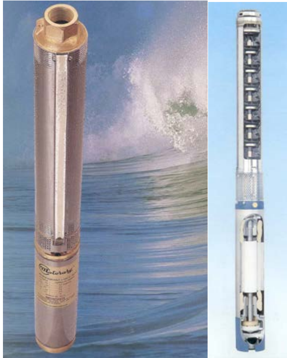
Foto 45: Electrobomba sumergible. A la derecha, esquema del motor (parte inferior) y de las turbinas (parte superior).
