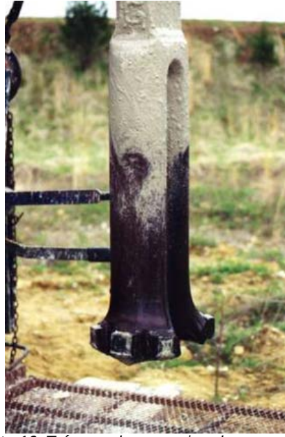
Foto 10: Trépano de un equipo de percusión.
