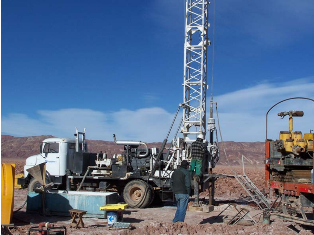
Foto 20: Equipo de diamantina con torre tradicional (perforación a 90°).
