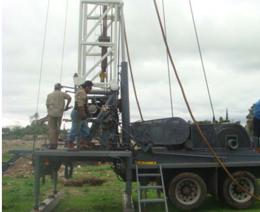
Foto 15: En el mástil o torre, se observa suspendido el vástago y el cuadrante que se inserta en la mesa.
