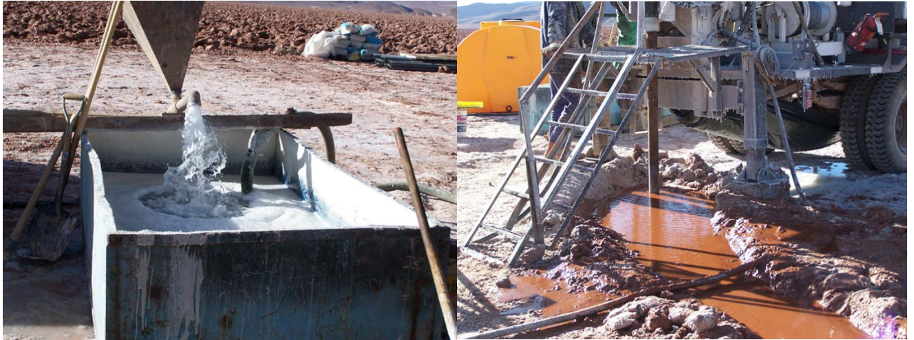
Foto 26: Preparación (izquierda) y circulación de lodo (derecha) en la perforación de diamantina.
