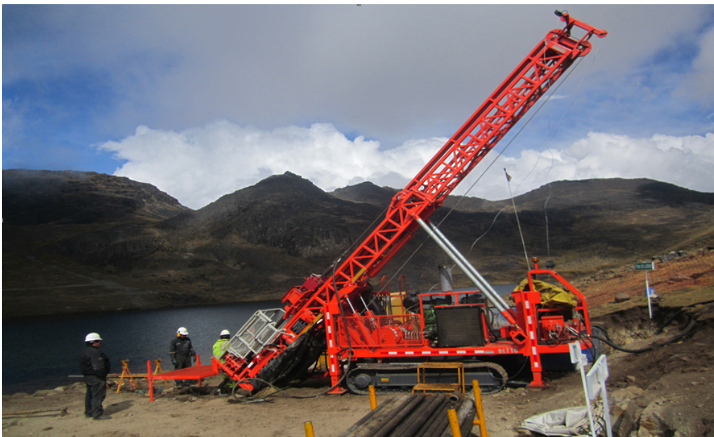
Foto 21: Equipo de diamantina con torre rebatible (perforación con ángulo distinto a 90°).
