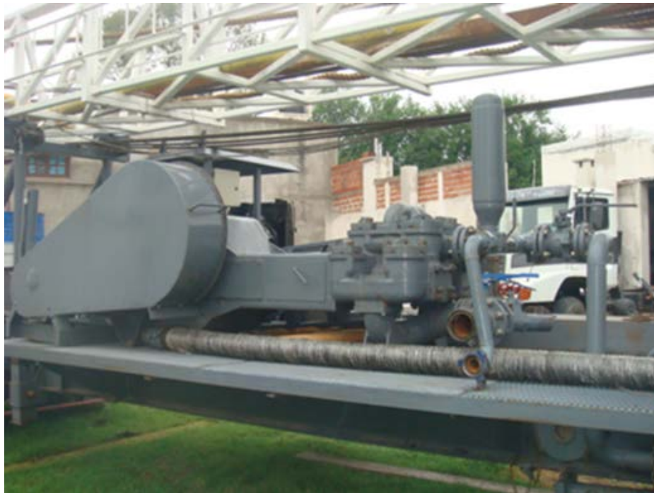
Foto 17: Bomba de lodo de dos pistones.
