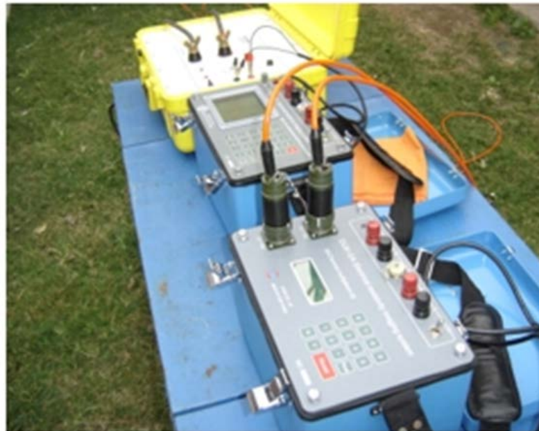
Foto 3: Equipo de prospección eléctrica en corriente continua (2010).
