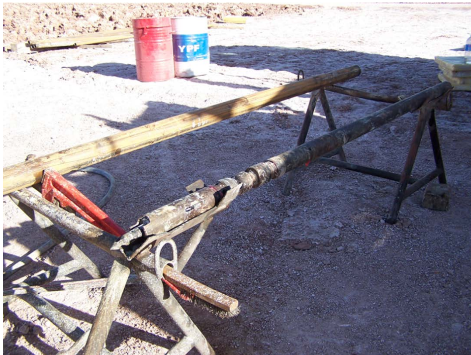
Foto 27: Arpón y barril para recuperación de corona testigo.
