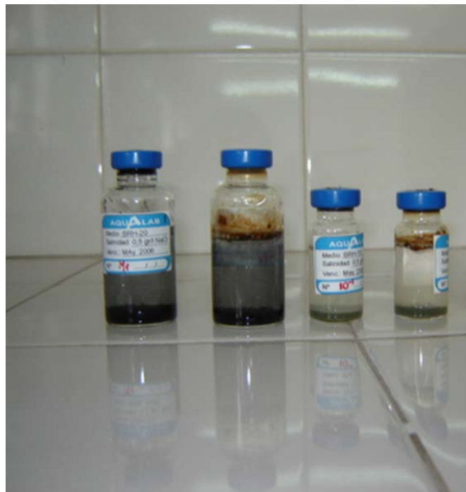
Foto 55: Precipitado negro debido a la presencia de bacterias sulforeductoras.
