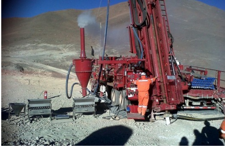
Foto 30: Equipo de aire reverso, con ciclón a la izquierda.
