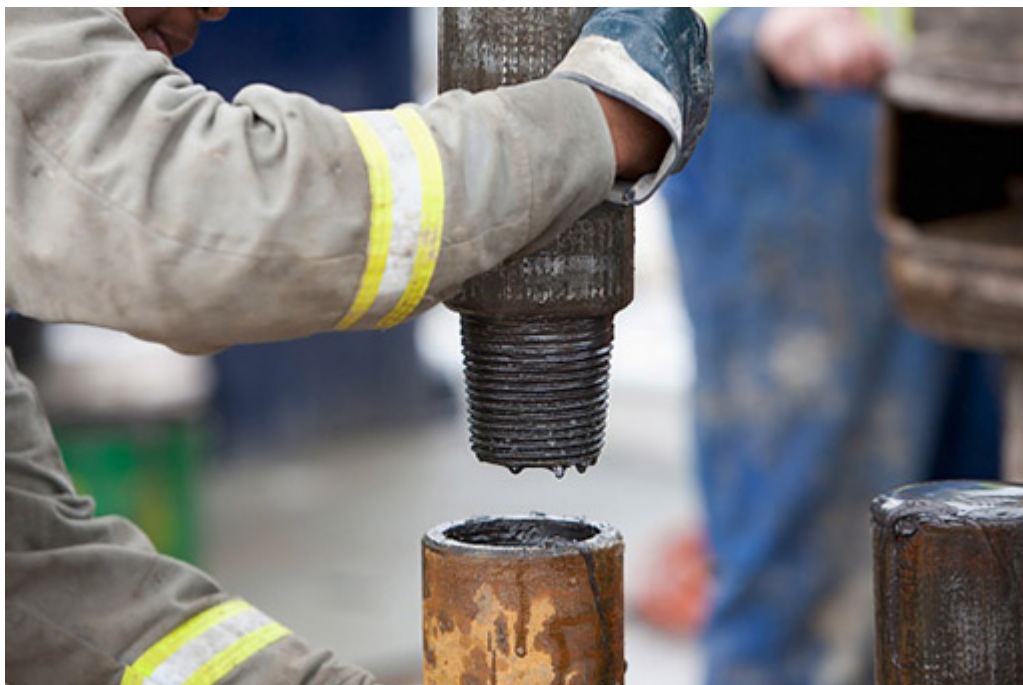
Foto 14: Barras de sondeo. Se observa rosca macho y hembra, cónica.
