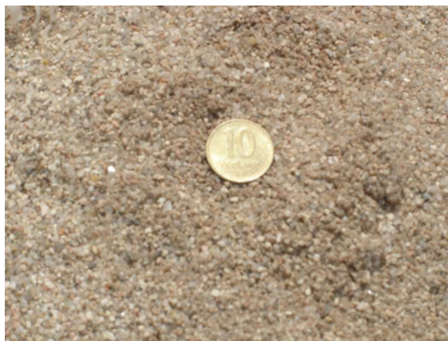
Foto 42: Material prefiltrante altamente seleccionado y redondeado de cuarzo.
