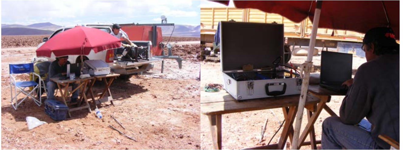
Foto 38: Equipo de perfilaje de pozos. Registro de SP, SPR, RNC, RNL y Gamma en el Salar de Pozuelos (Provincia de Salta).
