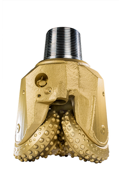
Foto 34: Cabezal tipo tricono o trépano tricono para aire reverso.
