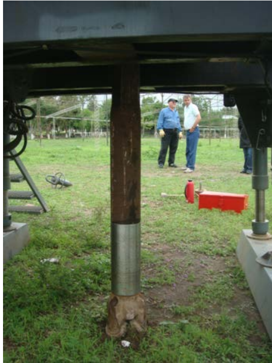
Foto 13: Trépano y Portamechas o barra de peso.
