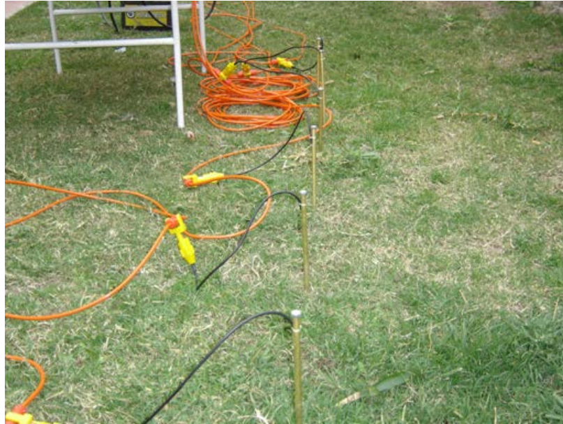
Foto 5: Cables multielectrodos con nodos de contacto y electrodos.
