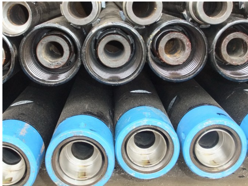
Foto 31: barras dobles o barras de doble pared para aire reverso.
