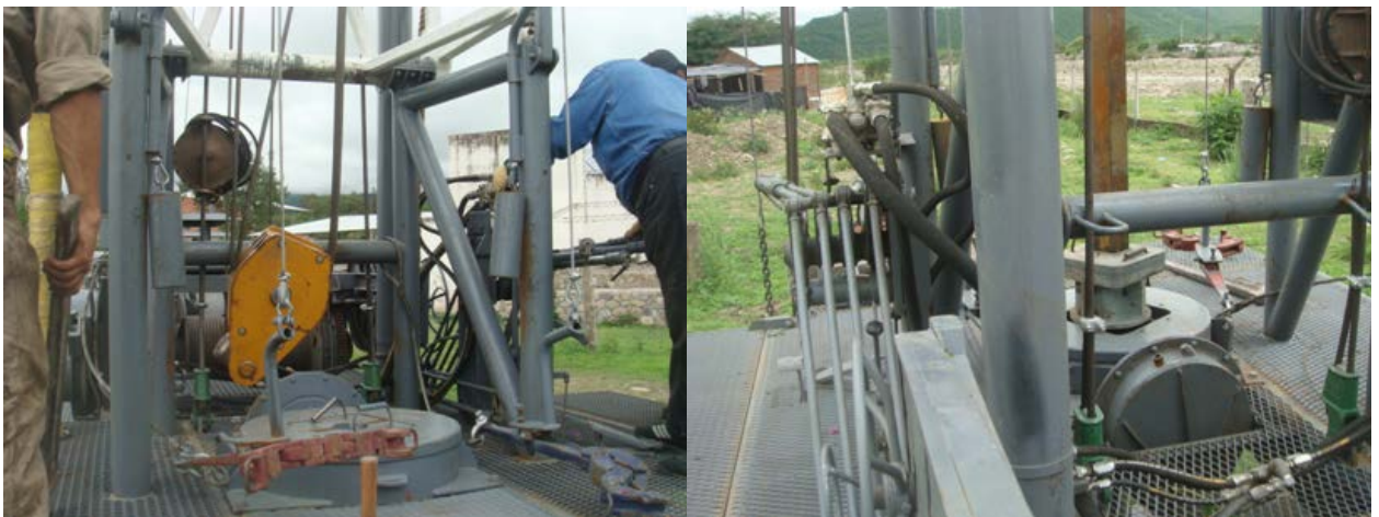
Foto 16: Mesa rotativa vista desde el frente (izquierda) y mesa rotativa vista desde atrás, con vástago y cuadrante (derecha).
