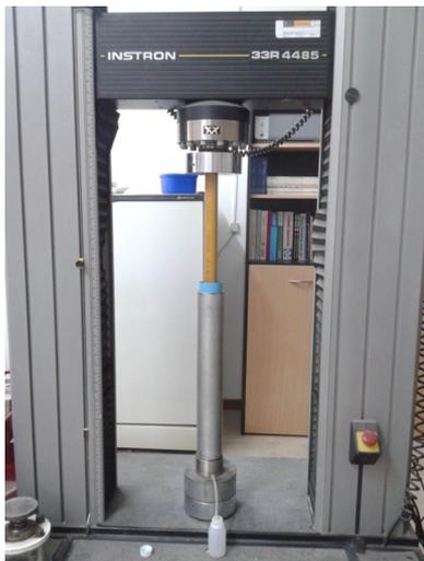
Extracción de agua poral de testigos con prensa
