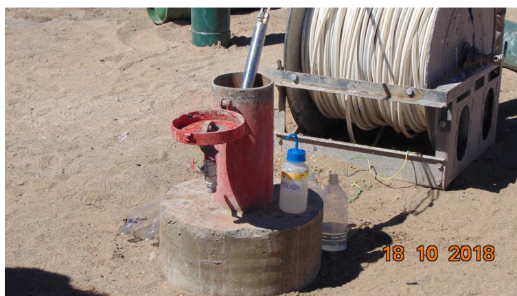
Figura 20. Equipo packer para extracción de muestra de salmuera.
