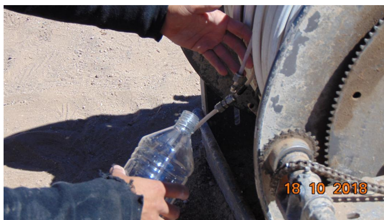
Figura 21. Extracción de salmuera desde el pozo 20D.
