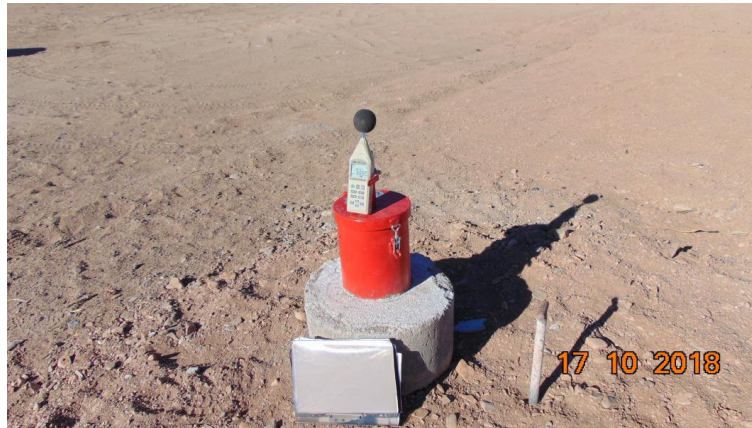
Figura 30. Medición de ruidos en PZ7.
