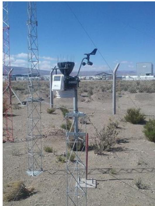
**Foto 2.** Vista de la Nueva Estación meteorológica instalada en inmediaciones del campamento actual.
