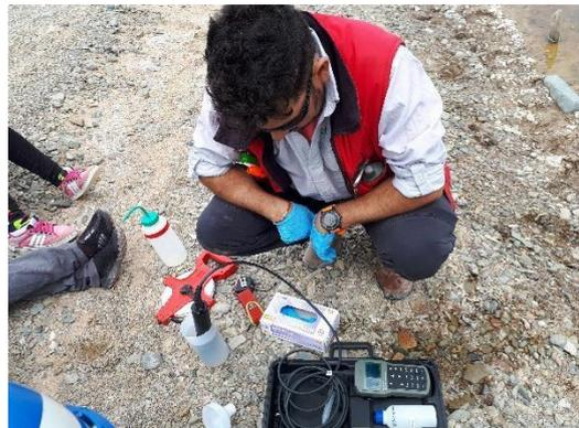
Imagen 3: Medición in situ con multiparamétrico.
