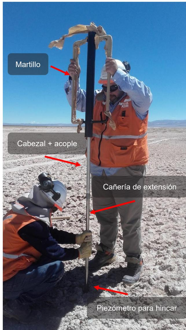
Foto 23. Vista de la instalación de un DP.
