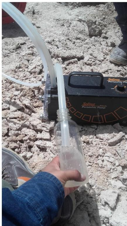
Foto 25. Vista del uso de la bomba y toma de muestra de agua.
