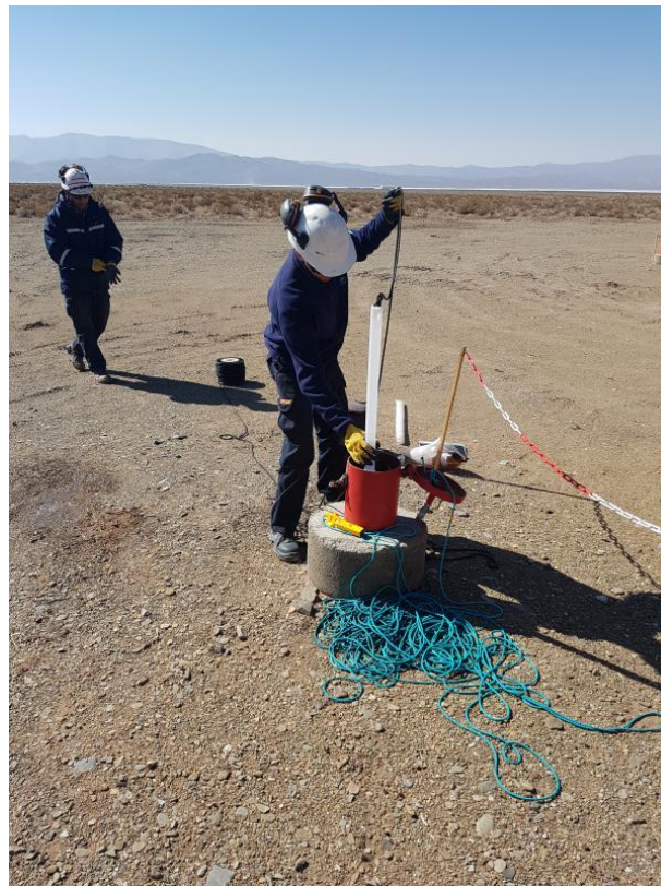
Figura 5.1. Equipo packer para extracción de muestra de salmuera.
