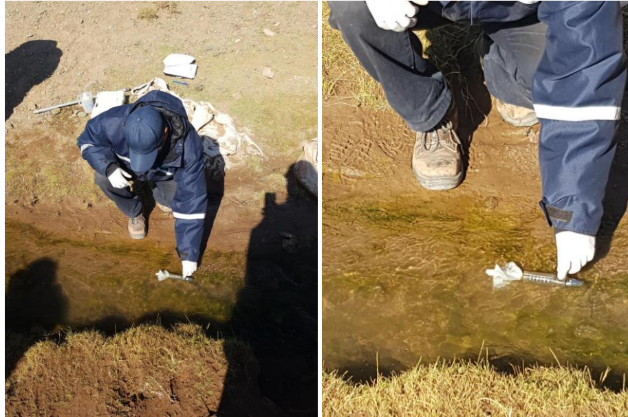
Figura 4.4. Medición del flujo del curso.
