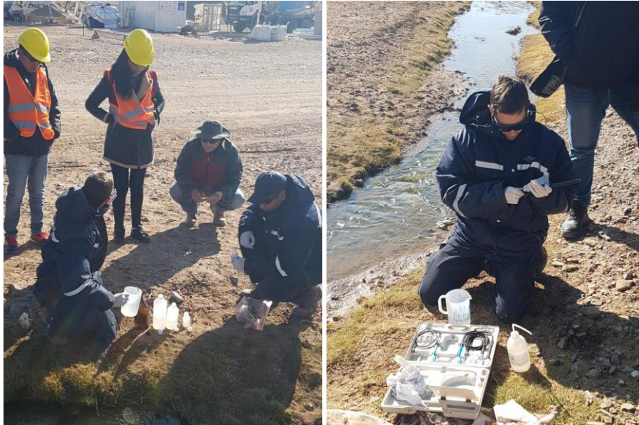
Figura 4.2. Toma de muestra de agua y medición de parámetros in situ en Vega Archibarca (a la vera de la ruta N° 52).
