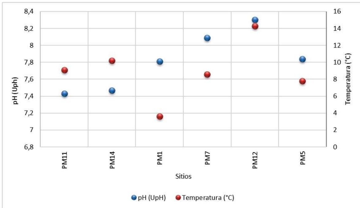
Figura 6.1. Perfil de pH y Temperatura in situ en aguas superficiales.
