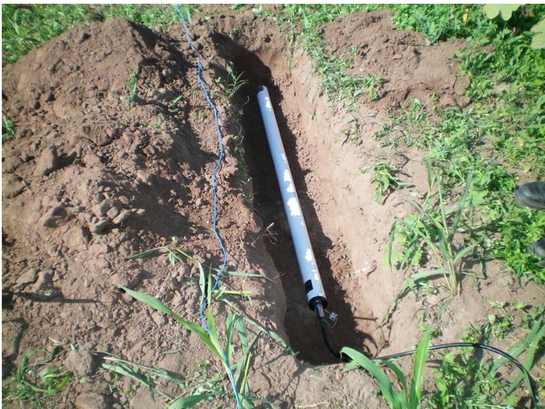
Foto 3: Sensor magnético X conectado al equipo receptor.
