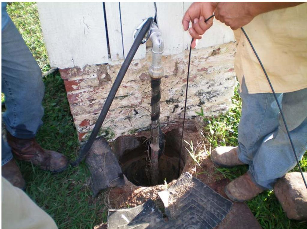
Foto 10: Pozo en Estación de Aforos Río San Francisco. Constatando profundidad y midiendo nivel estático.
