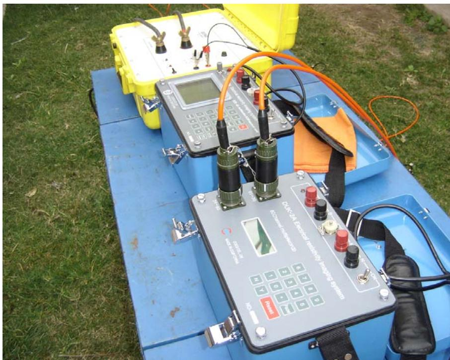
Foto 1: Equipo de geoelectrica en corriente continua.
