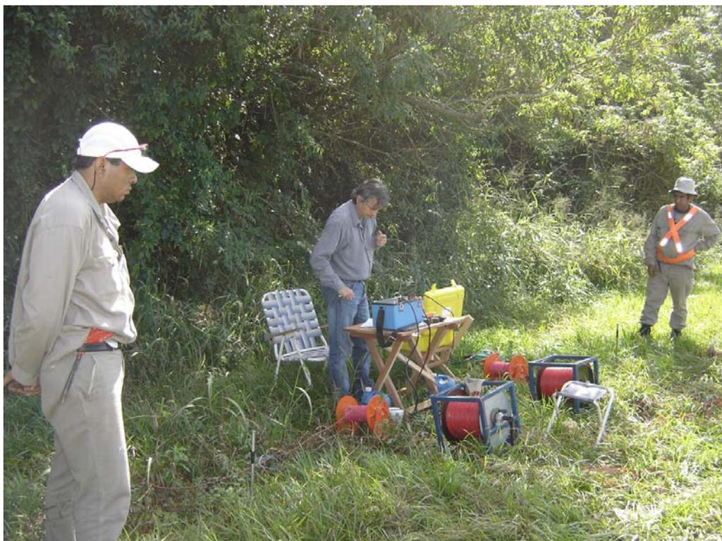
Foto 7: Ejecución de Sondeo Eléctrico Vertical sobre la ruta provincial N° 1.
